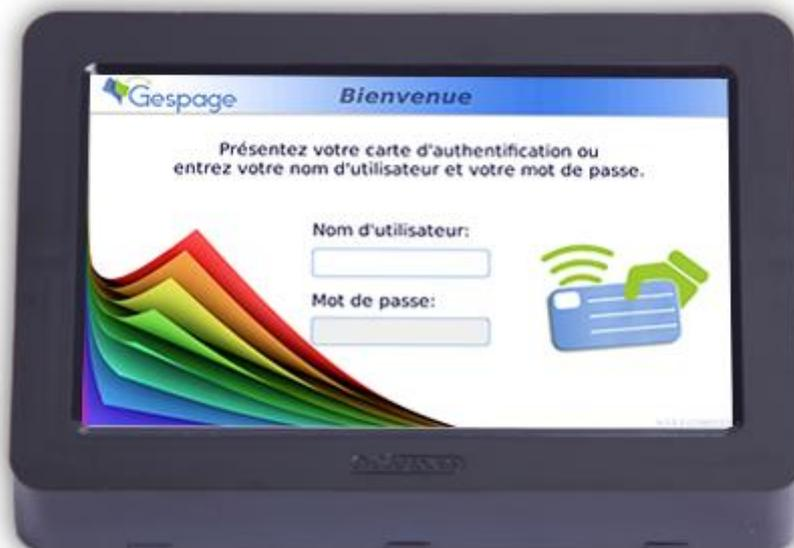
Le **cPad** est un terminal réseau externe, équipé d'un écran tactile, qui permet de libérer les travaux d'impressions à partir de n'importe quel périphérique. Les copies, impressions et scans sont comptabilisés et remontés vers
